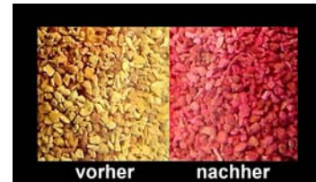
Abbildung 1: menex ® ™ -MOMS vor (links) und nach (rechts) Säure-Durchströmung.
